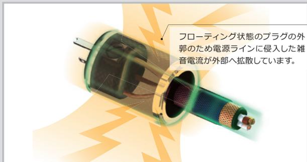
フルテック独自技術の「アースジャンパー機能 (USA Patent No. 6,669,491)」は上記の図のように悪影響を及ぼすノイズ電圧の流れを右上図のとおりフローティング状態にある電源コネクタの構成部品を導電性の金属プレートと導電性スプリングでアース端子までの回路を構成し、アースに確実に落とし込むことにより、ノイズのプラグ外への放出を防ぎ、電極間の電位差をなくし、整えます。
